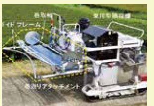
巻取アタッチメント前部取付
